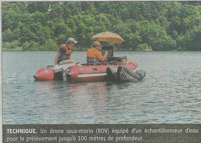
TECHNIQUE. Un drone sous-marin (ROV) équipé d'un échantillonneur d'eau pour le prélèvement jusqu'à 100 mètres de profondeur.
